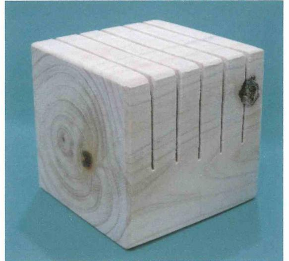
東濃桧の角材に鋸(のこぎり)を使って、切込みを入れることに木の香りが引き立ちます。最後に、サンドペーパーを使ってきれいに磨くと完成です。机の上に立てればメモスタンドにもなります。
